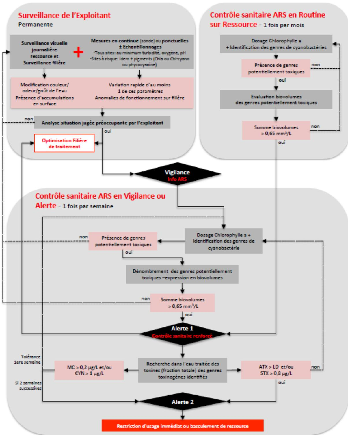
Figure 1 : Proposition de stratégie de surveillance et de contrôle sanitaire des EDCH vis-à-vis des cyanobactéries planctoniques.
