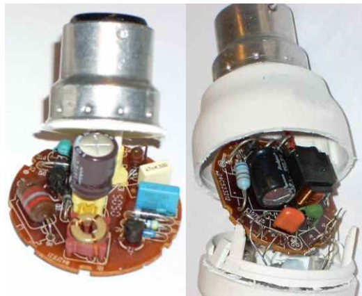
Figure N°3 : ballasts électroniques de lampes fluo-compactes
